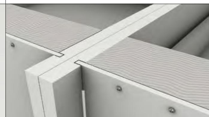
**Mit der Seitenwand verklebte**, beidseitig beschichtete Korpusrückwände zur Vermeidung von Feuchtigkeitsschäden.
